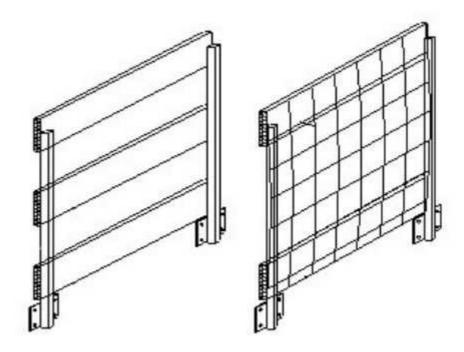
Parapetto provvisorio con corrente intermedio (sinistra) e con protezione intermedia (destra).
